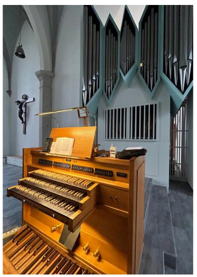
haltete. Ebenso wurde eine einfache elektronische Setzeranlage nachgerüstet, welche die Möglichkeiten des Instrumentes erheblich erweitert. Bei der innerhalb einer solchen Maßnahme immer stattfindenden Neuintonation wurde Wert darauf gedie neobarocke legt, Schärfe der Orgel in eine etwas grundtönigere Klangrichtung zu ändern. Alle wurden Register dabei lediglich übernommen. beim Choralbass im Pedal, welcher ursprünglich aus einer 4' und einer 2' Reihe bestand, wurde die
